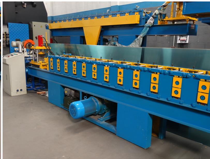
Com sistema operacional de ótima qualidade, a Perfiladeira Atrax é uma gigante com fatiamento por guilhotina hidráulica para perfilar chapas meia cana, aperfeiçoando a montagem em portas automáticas de enrolar. alta resistência operando com bobina de 0.80 x 125 mm. Com um conjunto de 14 roletes e sistema elétrico eletrônico CLP Schneider com excelente produtividade, qualidade e precisão.
