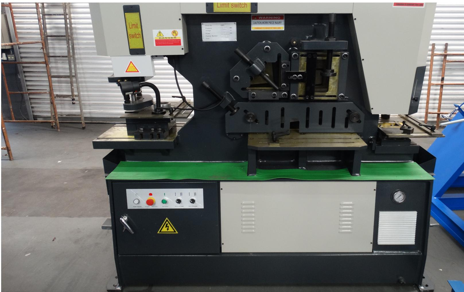
A Metaleira é uma máquina compacta e muito versátil com múltiplas funções. Opera com muita rapidez, possibilita cortes de vários materiais, além de furar por puncionamento furos redondos, oblongo ou furos especiais. Obtém amplo número de opcionais, tais como navalhas para cortes de perfis, recorte triangular, ferramentas para geração de arruelas abauladas com uma única batida, entre outros.
